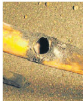
Arbeiten am Tage: Die beschädigten Leitungen in der Zugspitzstraße sind repariert. Rechts: das Loch in der ausgebauten Gasleitung.
